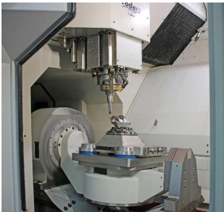
Ein Blick in den Arbeitsraum der RXU 1001 mit der massiven, dank Führungen an allen vier Ecken äußerst steif ausgelegten Z-Achse sowie dem speziellen, von Fa. Wiegemann entworfenes Spannsystem (Foto: Klaus Vollrath)
