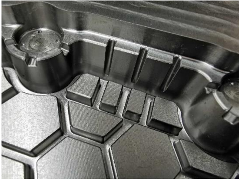
Detailaufnahme einer mit der RXU1001 bearbeiteten Stahlform (Foto: Klaus Vollrath)
