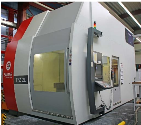
Zum Maschinenpark gehört auch eine Tieflochbohrmaschine für Bohrtiefen bis 1.250 mm (Foto: Klaus Vollrath)
