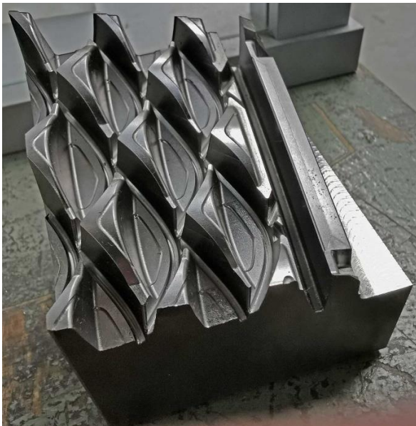
Herausforderung: Test-Bearbeitungsstück, welches bei Röders vor der Entscheidung gefräst wurde (Foto: Klaus Vollrath)
