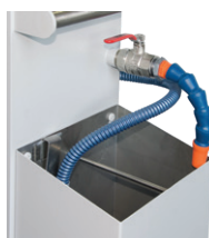
Idegen olajok kivezetése szinteltoltó tartályba (túlfolyás elleni védelem)
