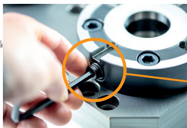
maximális meghúzási nyomaték = 60 Nm
