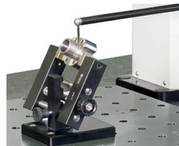
Steckbare Führungsanschlüsse und eine breite Palette an standardisierten Spannvorrichtungen sowie Werkstückaufnahmen erlauben die flexible Positionierung Ihres Prüflings.
